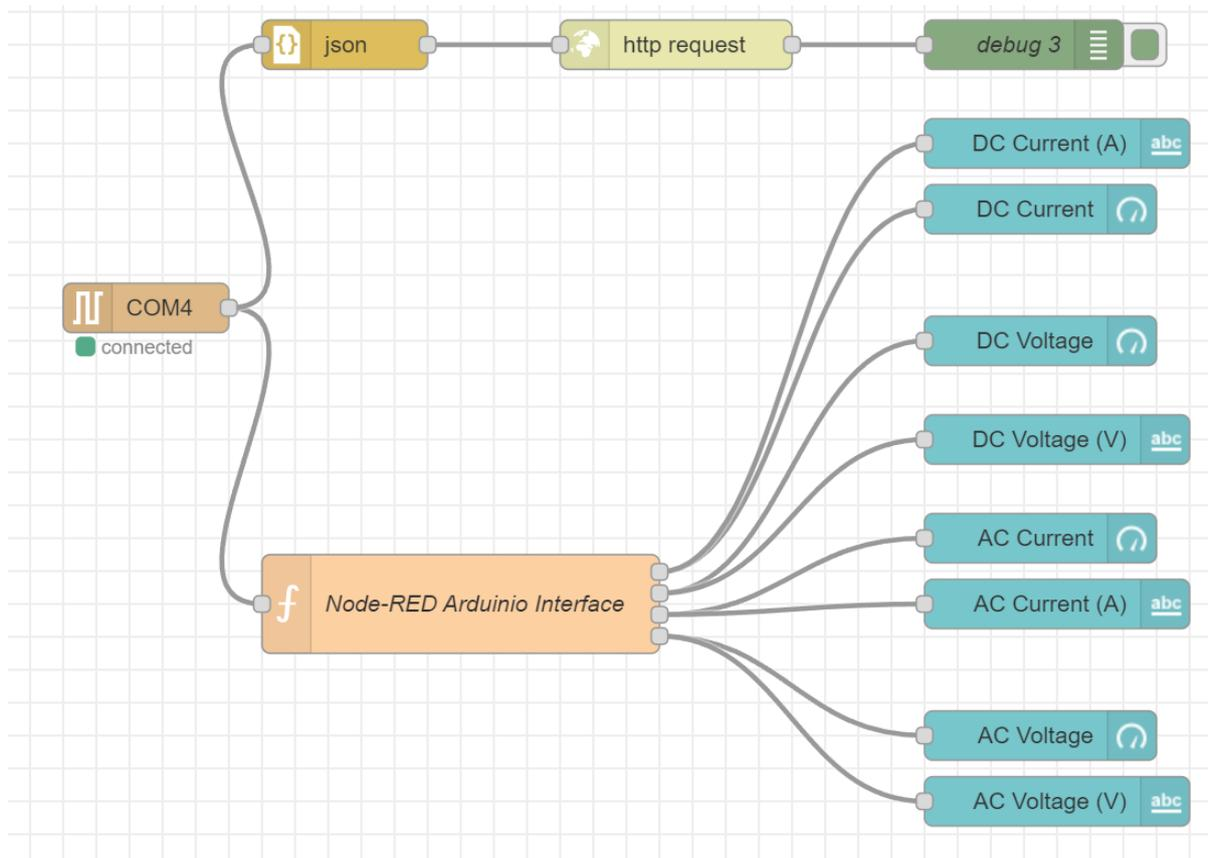
Fig. 5. Node-Red flow layout.
